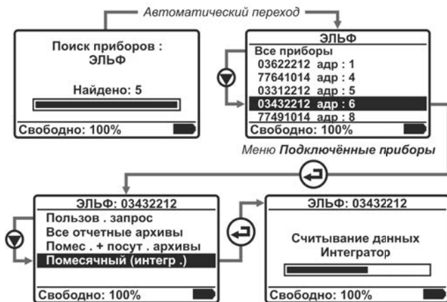
Рисунок 4.8 – Алгоритм работы пульта при получении данных с объединенных в сеть однотипных приборов учета
