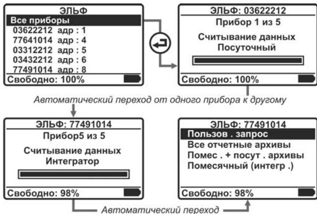
Рисунок 4.9 – Пример работы пульта с объединенными в сеть приборами учета в режиме получения данных Все приборы
